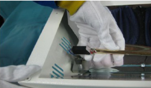
3. DESBLOQUEAR DE LOS RESORTES DE RETENCIÓN LAS GUARNICIONES DE SILICONA QUE REVISTEN LAS DOS EXTREMIDADES DE LA BOMBILLA.
