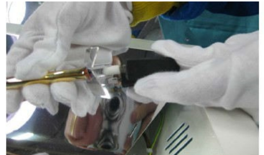
6. DIE FLACHSTECKER AN DER NEUEN LAMPE ANSCHLIESSEN UND DIE SILIKONDICHTUNGEN ÜBERSTREIFEN.
