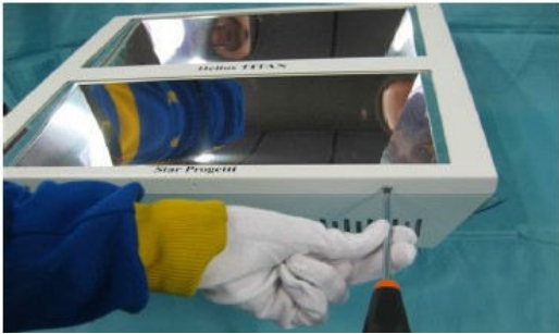
1. DIE ZWEI BEFESTIGUNGSSCHRAUBEN DES RAHMENS LÖSEN.
