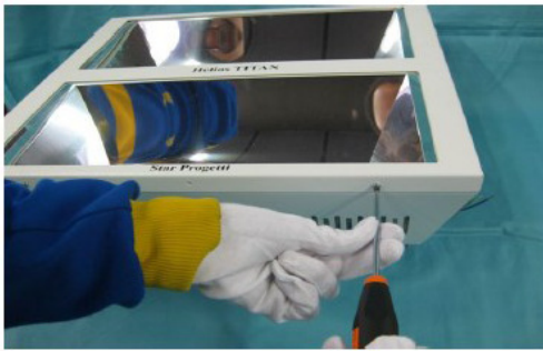
1. AFLOJAR LOS TORNILLOS QUE SUJETAN EL MARCO.
