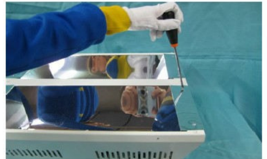
8. POSITIONNER A NOUVEAU LES DEUX PARTIES SUPERIEURES LATERALES DU REFLECTEUR ET LES VISSER
